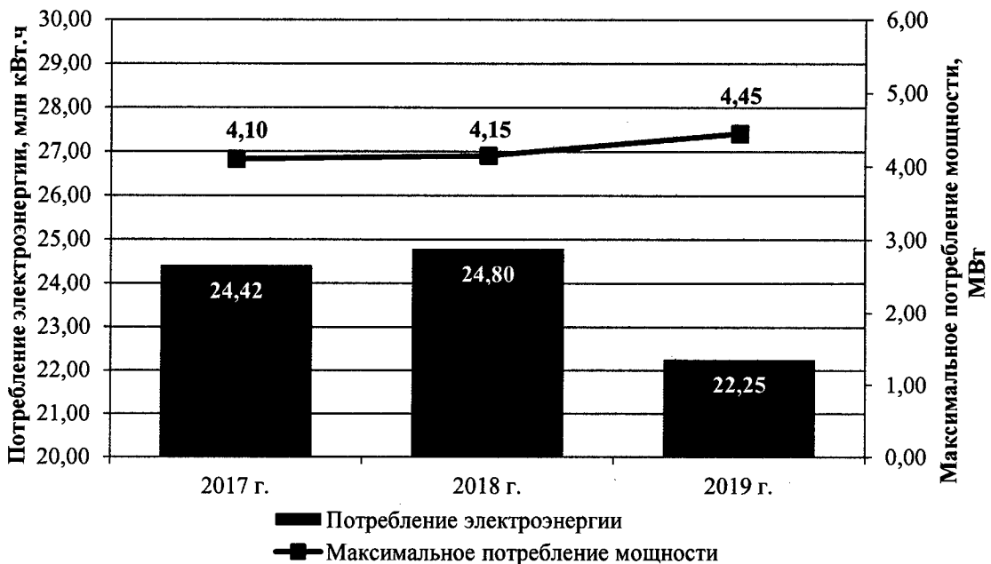
Рисунок 4.25. Динамика потребления электрической энергии и мощности «Шикотанского энергоузла» за отчетный период 2017 - 2019 гг.
