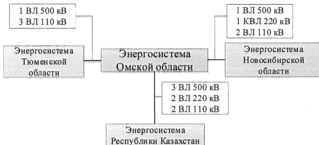
Рисунок 10 – Блок-схема внешних электрических связей ЭС Омской области
