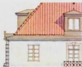
Фрагмент лицевого Ю-З фасада. Венчающий карниз
