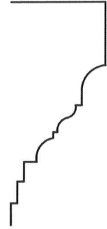
Профиль в завершении стен первого этажа
