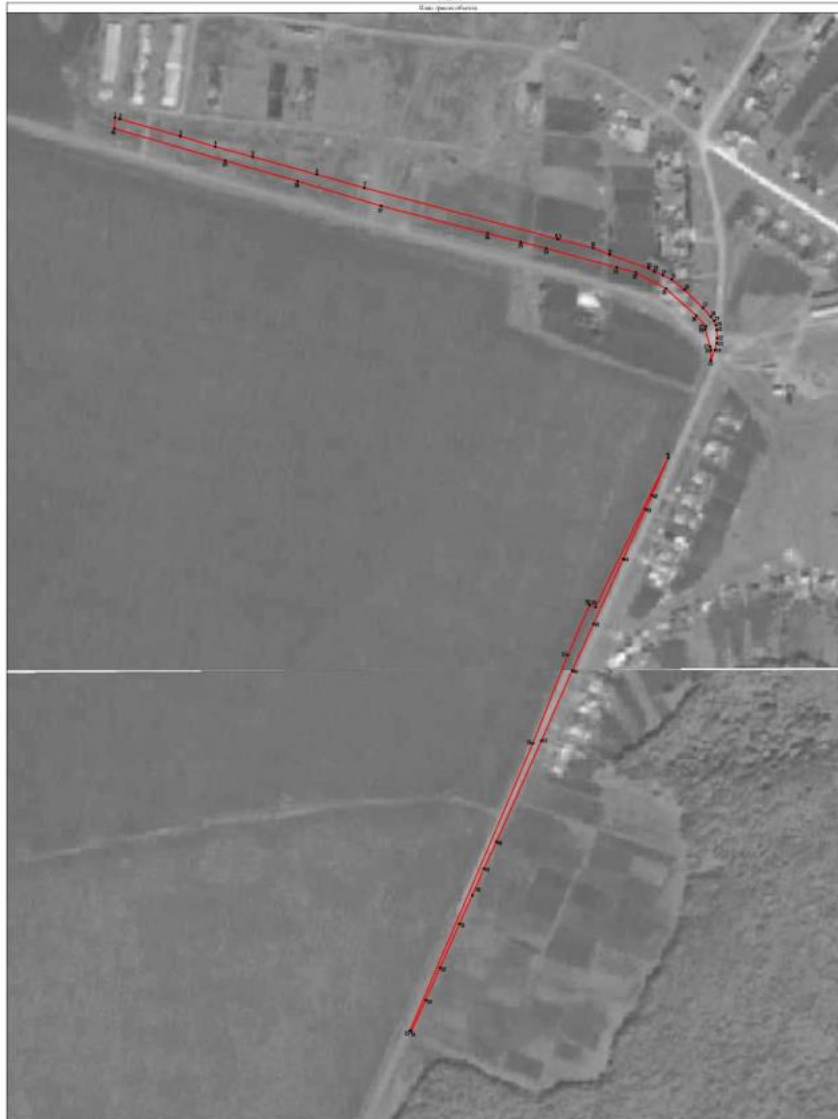
Рисун 4 План трасе водопровода
