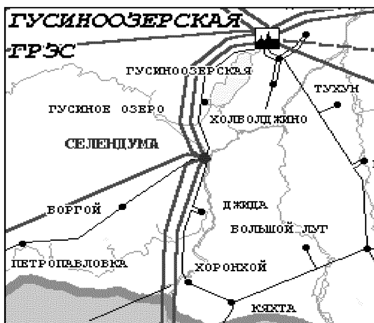
Рисунок 5. Южные сети ВЛ 110 кВ ГРЭС - Селендума
